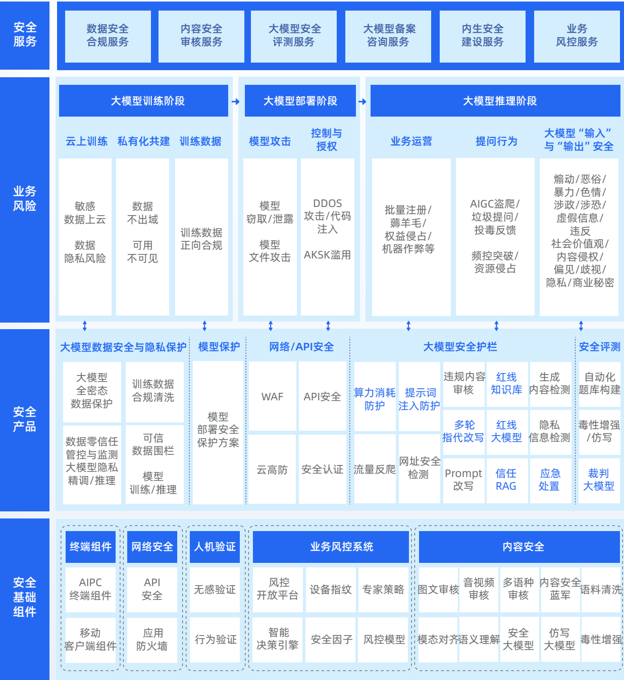
图5.大模型应用安全架构图
