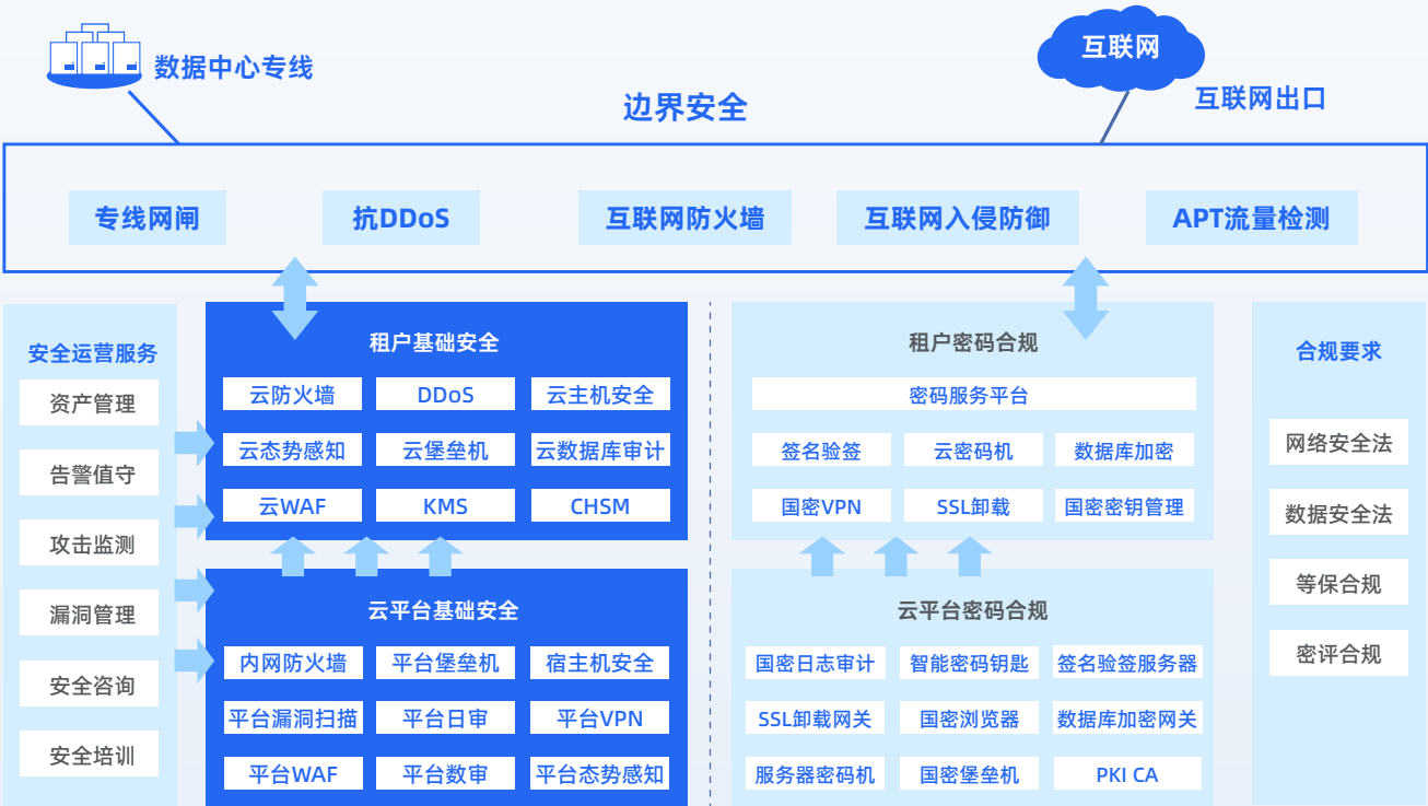
图18.某算力平台安全能力架构
